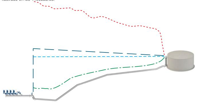
Los efectos del apagado de la bomba se resumen en la representación de la curva envolvente con los valores de presión máximos y mínimos obtenidos en la simulación (representados en rojo y en verde, respectivamente): el sistema alcanza el "vacío absoluto" a lo largo de buena parte del perfil, y un golpe de ariete es provocado por el desprendimiento de vena en correspondencia con el cambio de pendiente.
