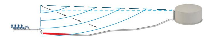
El esquema describe el perfil de una tubería, con bombas y depósito aguas-abajo. La línea punteada azul oscuro representa la HGL y la línea punteada azul claro la estática. Se observa la onda de presión negativa que se propaga aguas-abajo por efecto del apagado de la bomba; el segmento rojo corresponde al tramo afectado por la depresión durante la fase inicial del evento.
