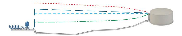
La figura muestra las consecuencias del transitorio, provocado por el apagado de las bombas, sobre una tubería protegida por el depósito A.V.A.S.T.. La curva roja y la verde describen los valores de presión máximos y mínimos obtenidos en la simulación; se observa claramente el efecto de eliminación de las presiones negativas y la reducción del golpe de ariete.
