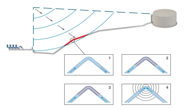
La segunda imagen muestra la propagación de la onda de presión negativa a lo largo de la tubería aguas-abajo. La parte expuesta a una fuerte presión negativa está resaltada en rojo. El cambio de pendiente constituye un punto en el cual se puede verificar la separación de columna líquida, cuando se forman bolsas de vapor y, por lo tanto, colapsan generando golpes de ariete peligrosos, como está ilustrado en los 4 recuadros.
