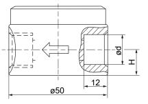
DN 6, 8: ød = 12 DN 10: ød = 16 Angle valve body H = 21 2/2-way body H = 13
